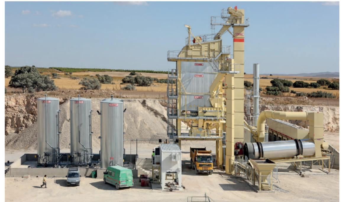
Planta asfáltica de 280 t/h (España). Con torre mezcladora InNOVA-G. Con tolvas en caliente de 160 t. Tanques de asfalto y fuel con calentamiento eléctrico. Mezclador de 4.000 kg. Provista de sistema de reciclado en frío con descarga en el mezclador.
