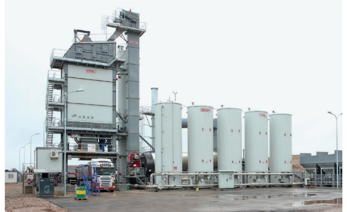
Planta asfáltica de 320 t/h (Polonia). Con torre mezcladora InNOVA-G con tolvas en caliente de 160 t. Tanques de asfalto con calentamiento eléctrico. Instalada sobre cimentaciones metálicas. Mezclador de 4.500 kg.
