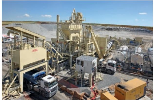
Trémie de 100 t installée dans une centrale d'enrobage M-280.
