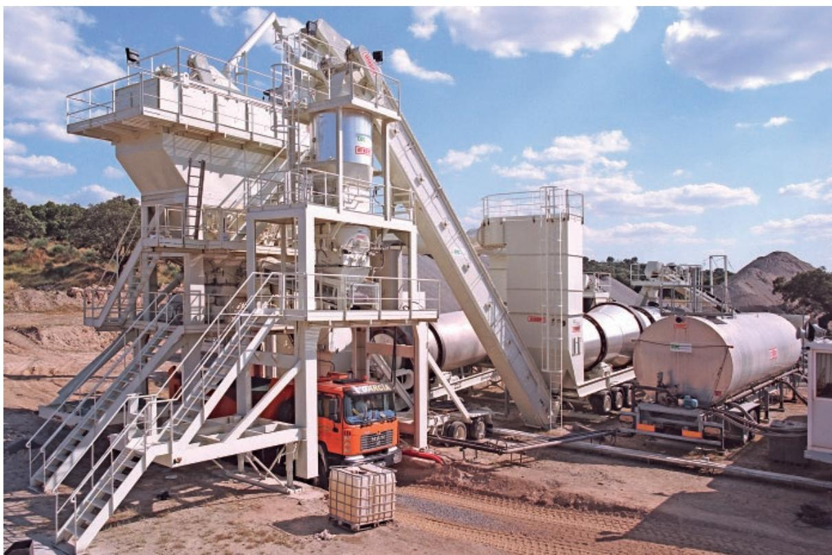
Équipement de recyclage avec procès à chaud RC-80 installé en une centrale UM-200 (Espagne).
