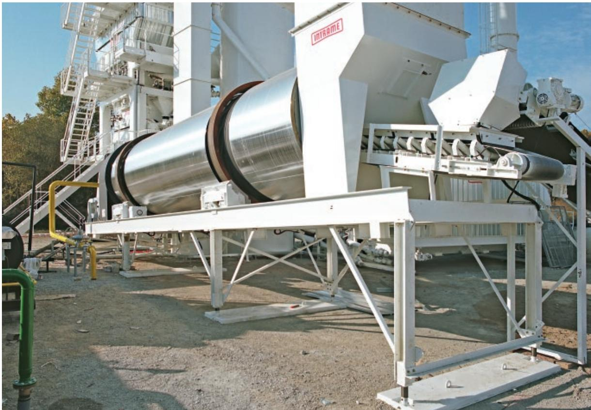
Détail des plaques d'appui du sécheur.
