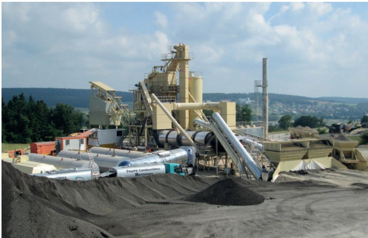
Équipement de recyclage avec procès à chaud RC-120 installé en une centrale M-280 (Suisse).
