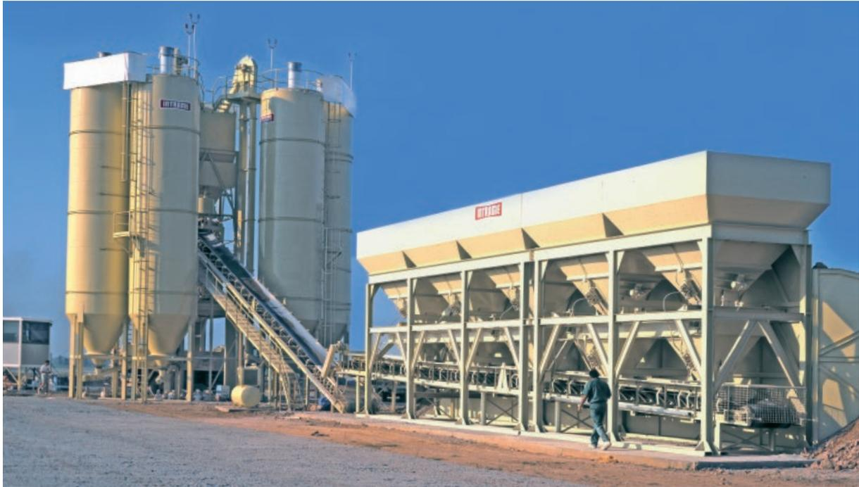
Centrale à béton PH-150 avec malaxeur forcé à double arbre horizontal de 3 m<sup>3</sup> travaillant à l'aéroport de Barcelone.
