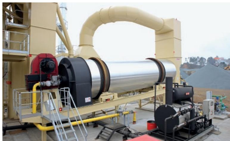
Sécheur de RM-280. D'un haut rendement. Équipé avec brûleur d'une haute efficacité qui respecte les lois internationales plus strictes liées à l'environnement. Aussi, au premier plan se montre la chaudière d'huile thermique d'une haute efficacité énergétique.
