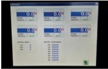
Nouveau terminal de contrôle de pesage (équipement auxiliaire).
