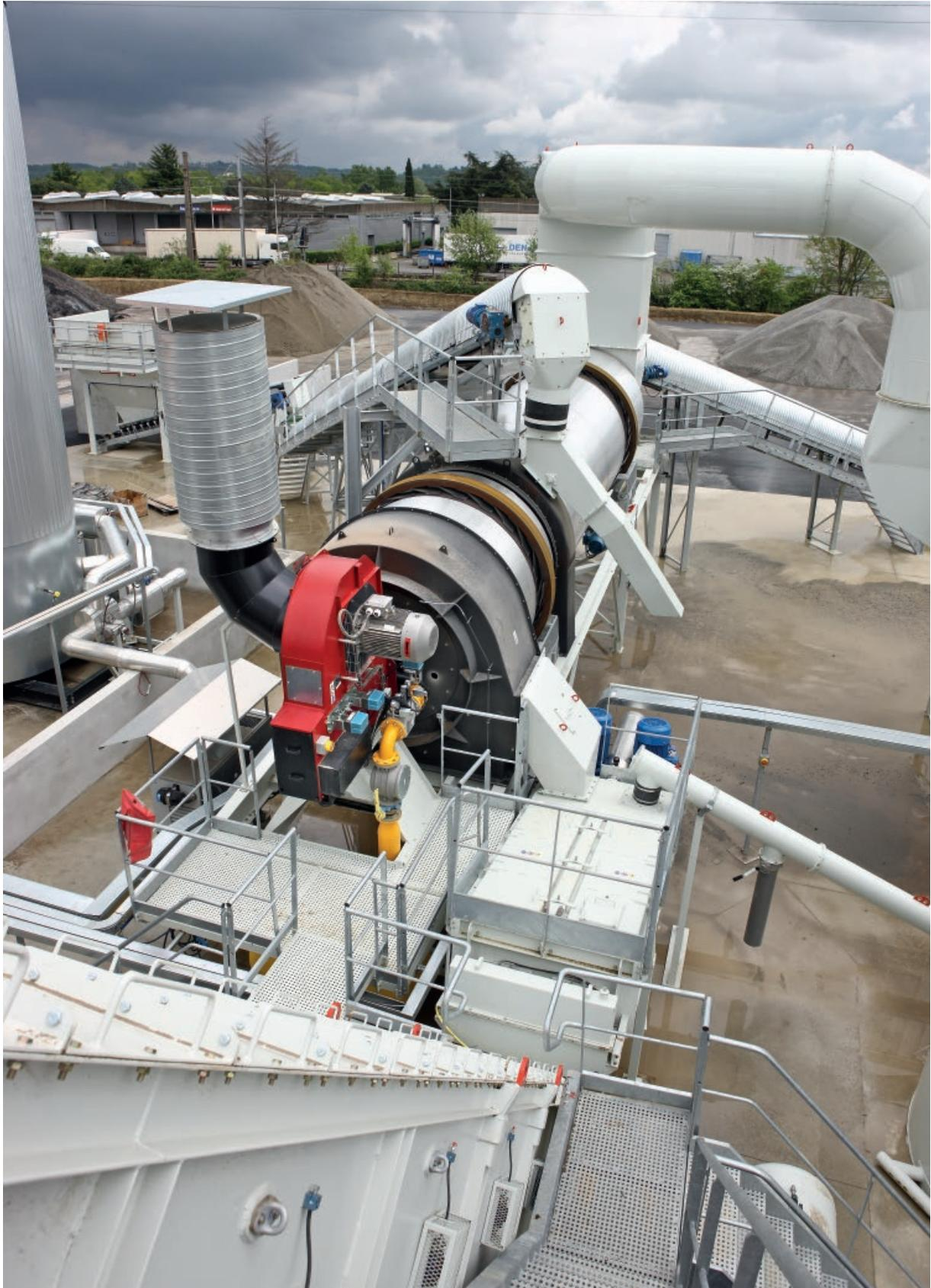
Sécheur et malaxeur d'une centrale continue Flow-Mix 220.
