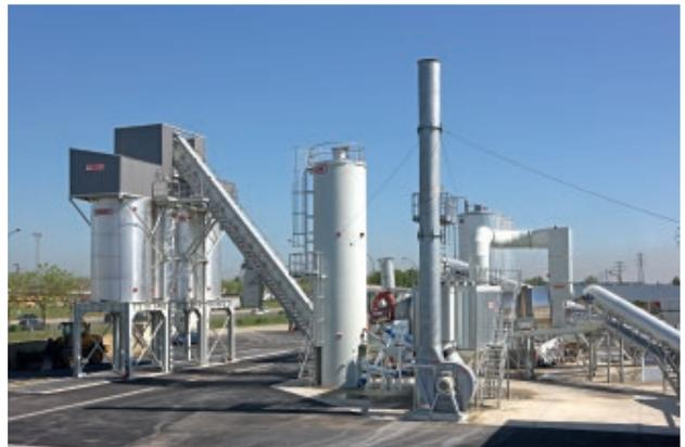
Batterie de quatre silos de 85 t chargés par une navette de déplacement horizontal qui ramasse l'enrobé du malaxeur par une navette élévatrice. Chaque silo dispose d'un système de pesage pour contrôler le chargement des camions.
