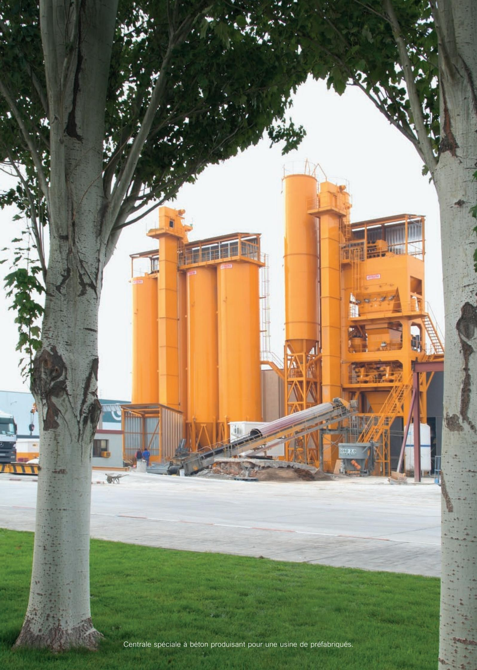
Centrale spéciale à béton produisant pour une usine de préfabriqués.
