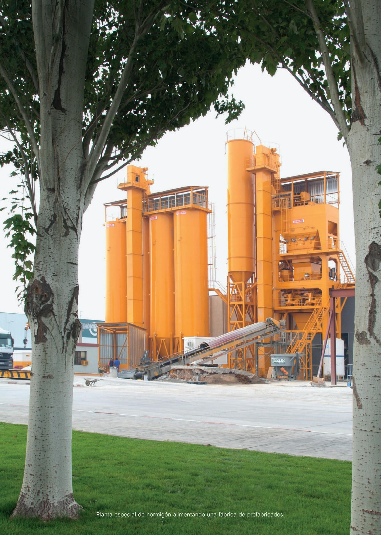
Planta especial de hormigón alimentando una fábrica de prefabricados.
