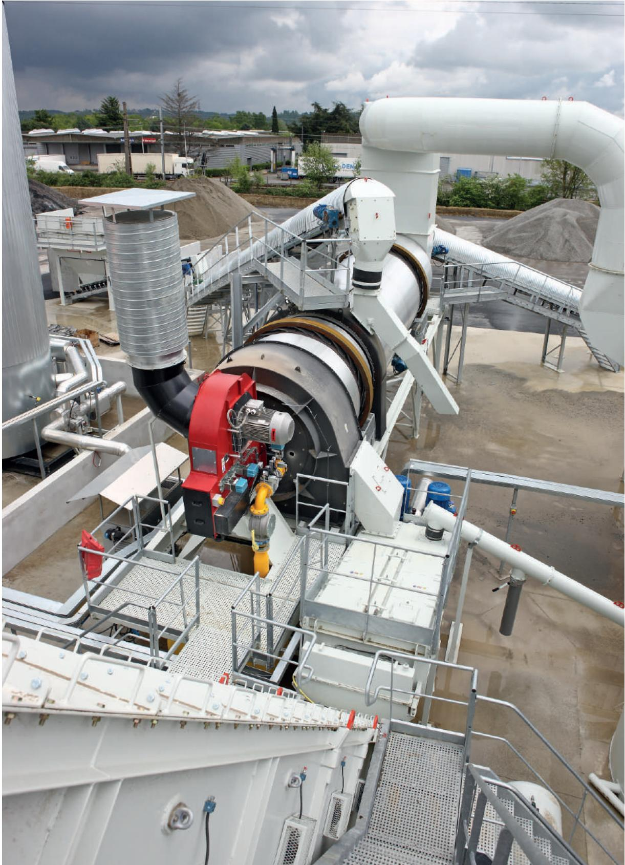
Secadero y mezclador de planta asfáltica continua Flow-Mix 220.
