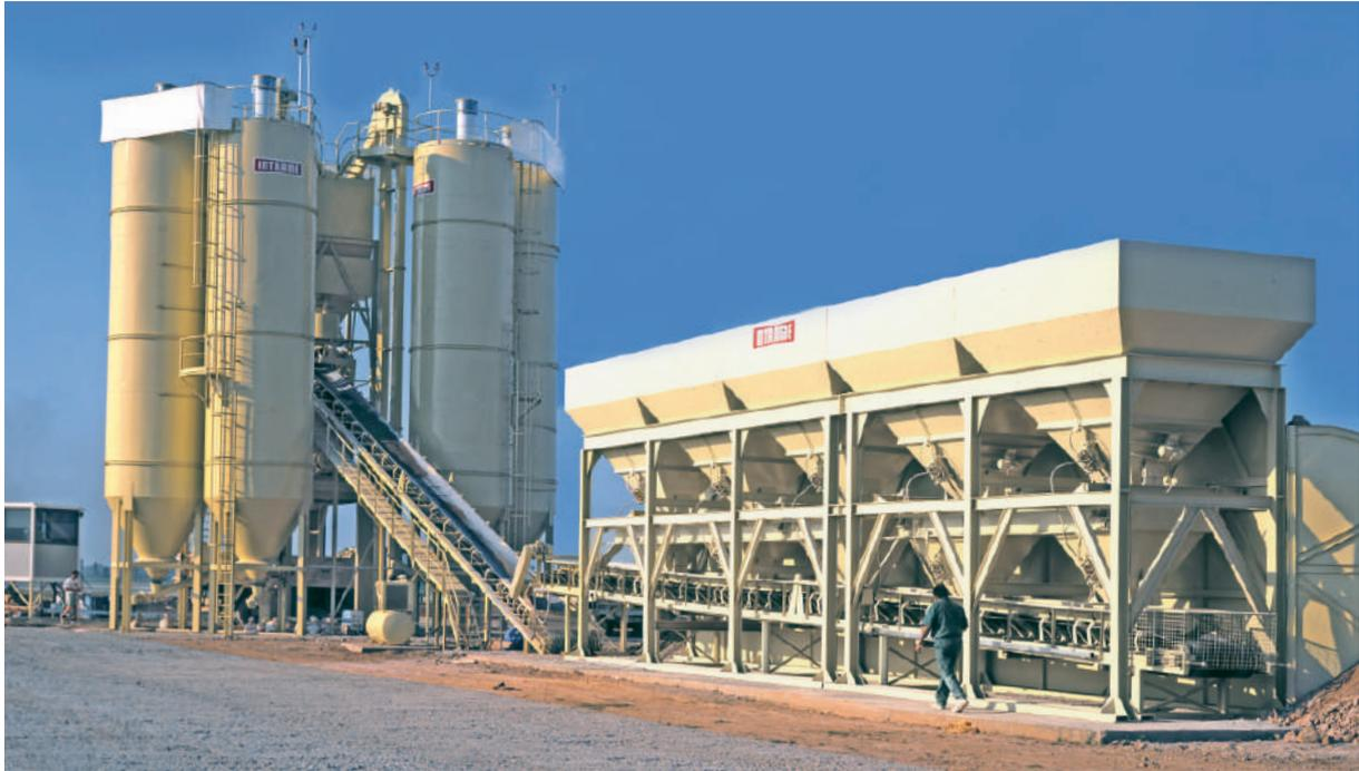
Planta de hormigonado PH-150 con amasadora forzada de doble eje horizontal de 3 m<sup>3</sup> (aeropuerto de Barcelona).
