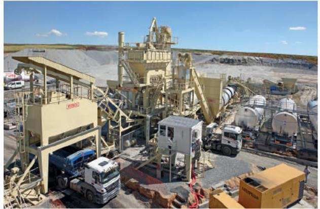
Silo de 100 t instalado en una planta asfáltica M-280.
