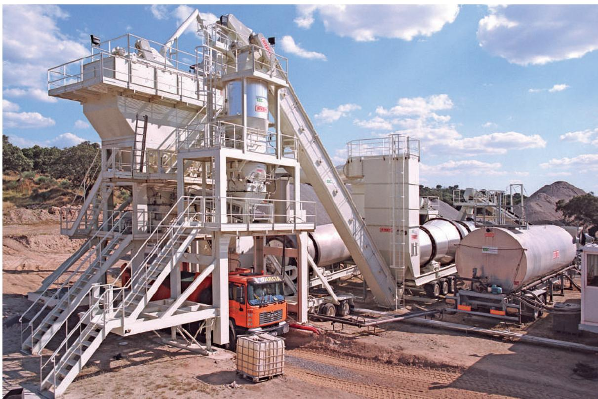
Equipo de reciclado en caliente RC-80 instalado en planta UM-200.
