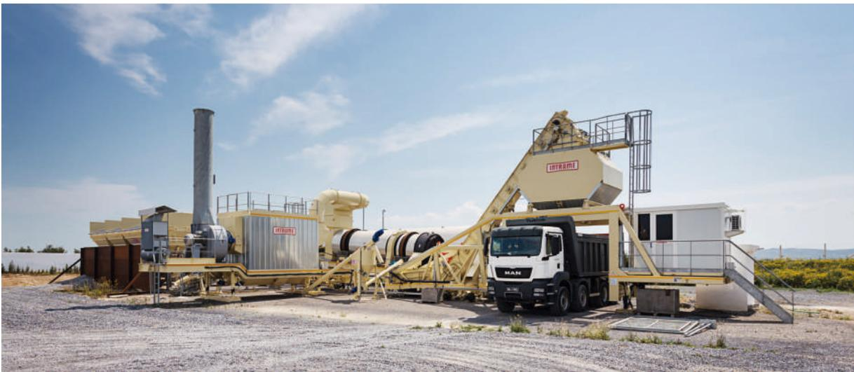
Planta asfáltica Flow-Mix 140 Móvil con silo.
